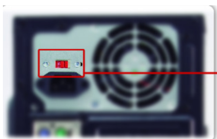
Localização da chave seletora na fonte (destaque em vermelho)
