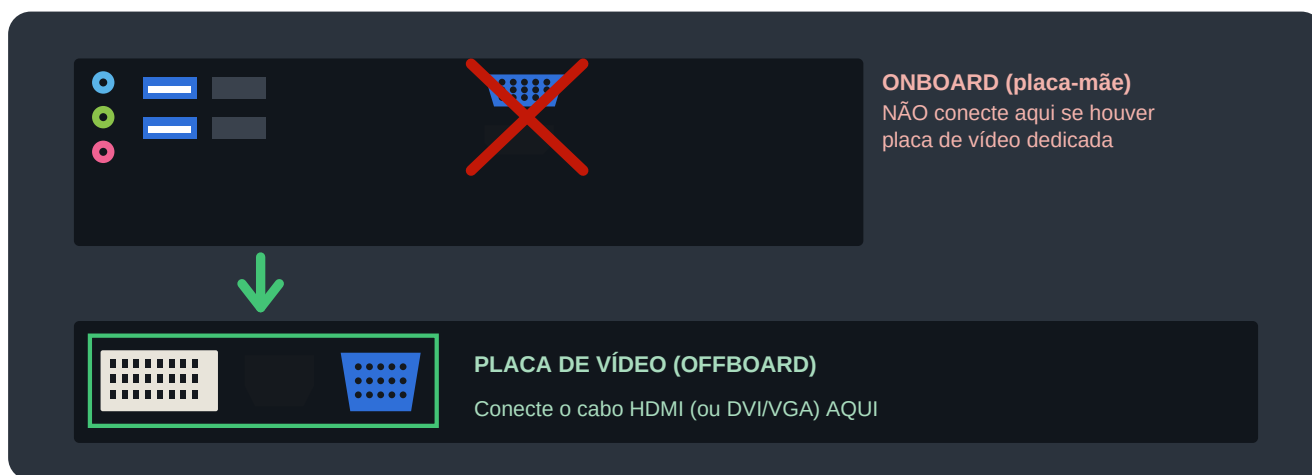
Saídas da placa de vídeo dedicada: DVI, HDMI e VGA (foto real)
